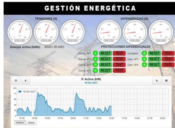
Gracias a la tecnología KNX se ha podido realizar el control completo de una instalación de frío industrial obteniendo una mayor funcionalidad y reduciendo el cableado de la instalación, así como integrar el control del resto de instalaciones de climatización e iluminación del edificio llegando a conseguir ahorros de hasta el 40% respecto un sistema convencional. La gestión remota de la instalación, así como los avisos vía e-mail garantizan la máxima continuidad de funcionamiento.
