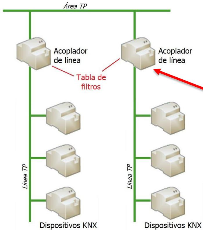
Las tablas de filtro en los acopladores de línea evitan que un hacker tenga acceso a toda la instalación
