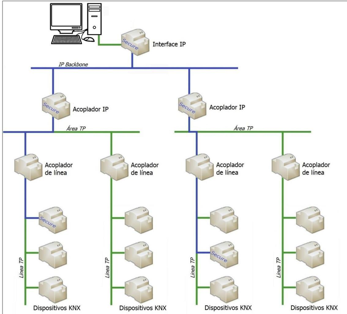
KNX Data Secure y KNX IP Secure pueden usarse simultáneamente en una misma instalación KNX.
